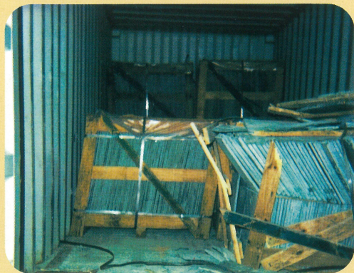
貨物の過重で床が壊れ、荷崩れしたコンテナ (98.3.30 名古屋港)
